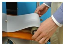
8. Удалите конвейерную ленту и полотно конвейера из головки датчика по направлению к ведомому ролику г.
