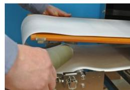
7. Удалите ведущий ролик, внимательно следя за тем, чтобы не захватить зубчатую передачу .
