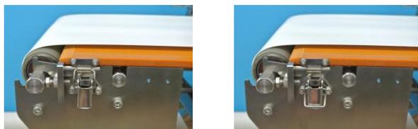
3. Извлеките корпус зубчатой передачи.
