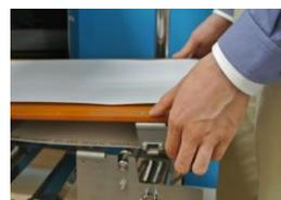
5. Поднимите ведомый ролик настила конвейера. Сдвиньте его на бок.
