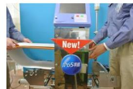
9. Вытащите конвейерную ленту из конвейерного полотна.
